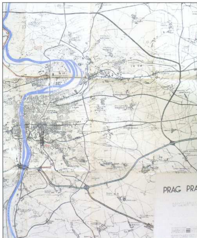
Plán sítě hlavních komunikací v Praze, včetně vyznačeného pražského okruhu a jeho napojení na dálnice směr Brno, Breslau (Vratislav), Norimberk, Berlín (NA).
